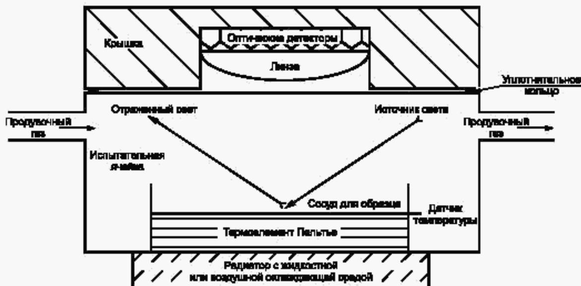
Рисунок А.2 — Схема испытательной камеры
