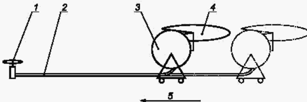
1 — источник воды; 2 — раздаточная труба; 3 — самоходная конструкция; 4 — устройство или система распределения воды: дождевальный аппарат, в том числе пушечного типа, штанга (на самоходной конструкции); 5 — направление движения
