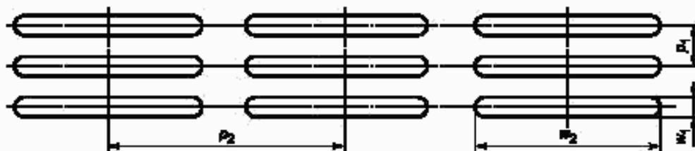
Рисунок 1— Лабораторные сита с продолговатыми округленными отверстиями
