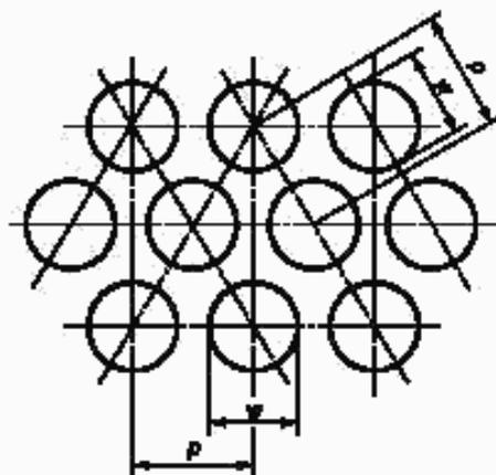
Примечание — Центры отверстий размещаются при вершинах равносторонних треугольников.
