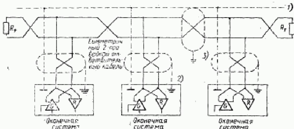
Рисунок 2 Двухпроводная многопунктовая конфигурация
