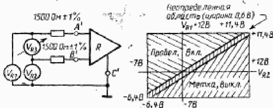
Рисунок 12 Измерение рассогласования на входе
