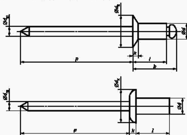
$h$  — слепая длина;  $d$  — диаметр заклепки;  $d_s$  — диаметр головки;  $d_n$  — диаметр сердечника;  $k$  — высота головки;  $l$  — длина заклепки;  $p$  — выступающая длина сердечника
