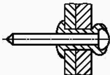
Рисунок 7 — Неразрывающийся вытяжной сердечник
