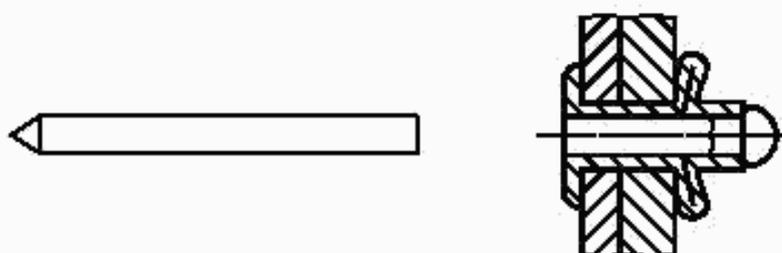
Рисунок 16 — Разрезной стержень
