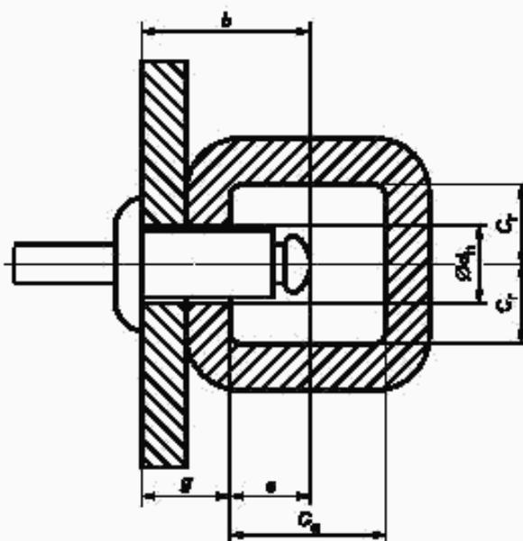
$b$  — слепая длина;  $C_a$  — осевой зазор со «слепой» стороны;  $C_r$  — радиальный зазор со «слепой» стороны;  $d_h$  — диаметр отверстия;  $e$  — выступающая длина «слепой» стороны;  $g$  — толщина пакета
