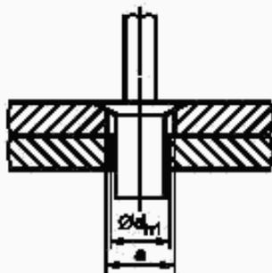
Рисунок 2 — Увеличенный диаметр отверстия для облегчения совмещения
