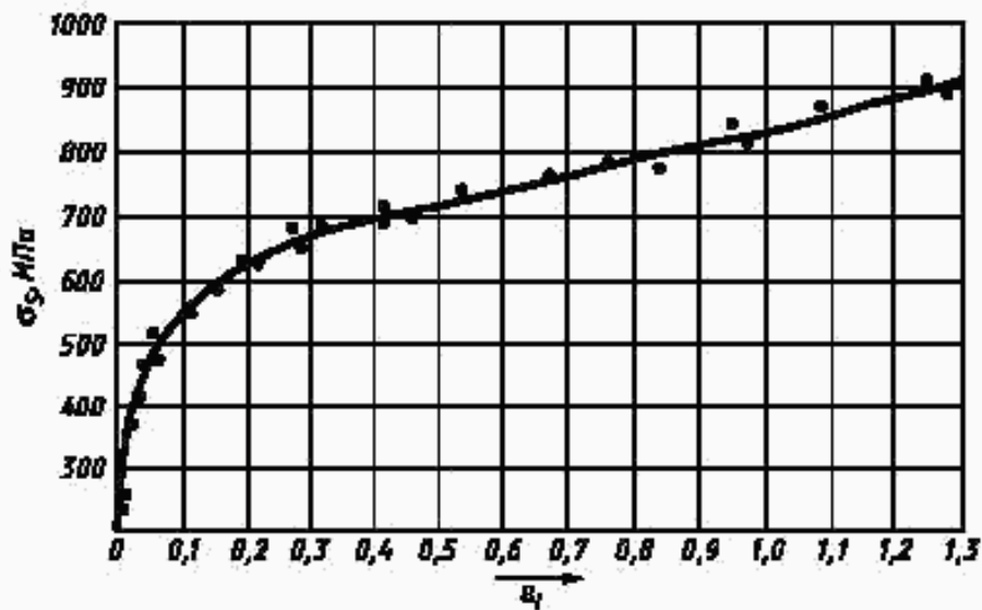
Рисунок 9 — Экспериментальная кривая упрочнения в координатах \sigma_{\text{т}} - \epsilon_{\text{т}}
