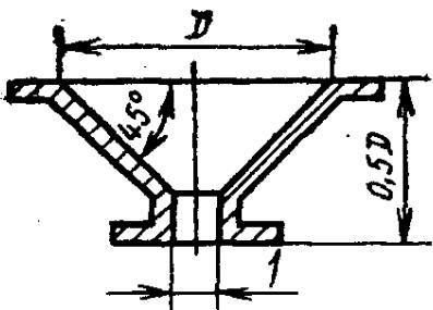
1—диаметр входного отверстия испытуемого насоса
