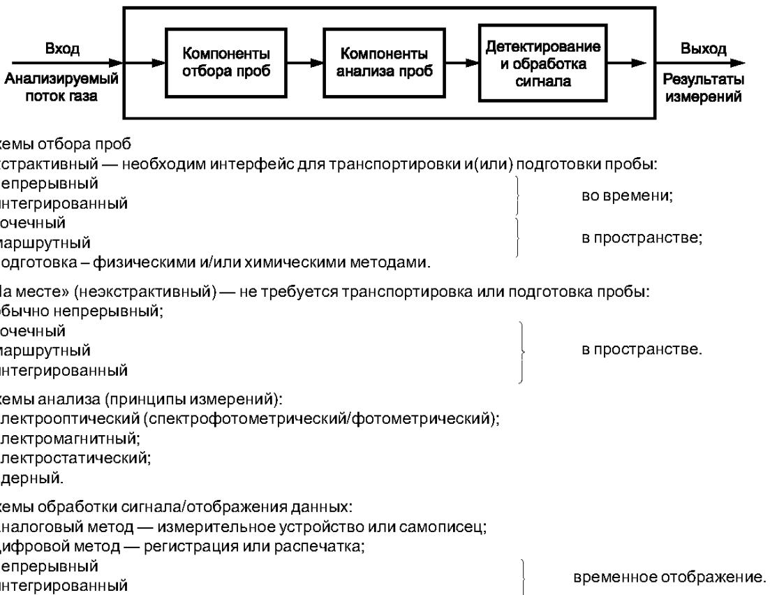
Рисунок D.1 — Варианты измерительной системы
