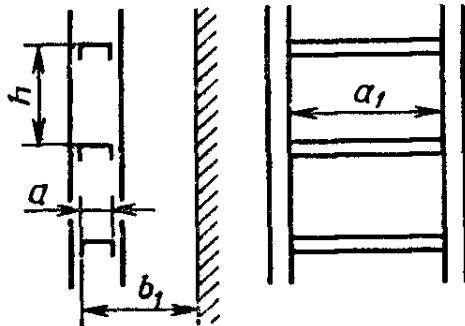
$b_1$  — свободная глубина;  $a$  — ширина опорной поверхности ступени;
