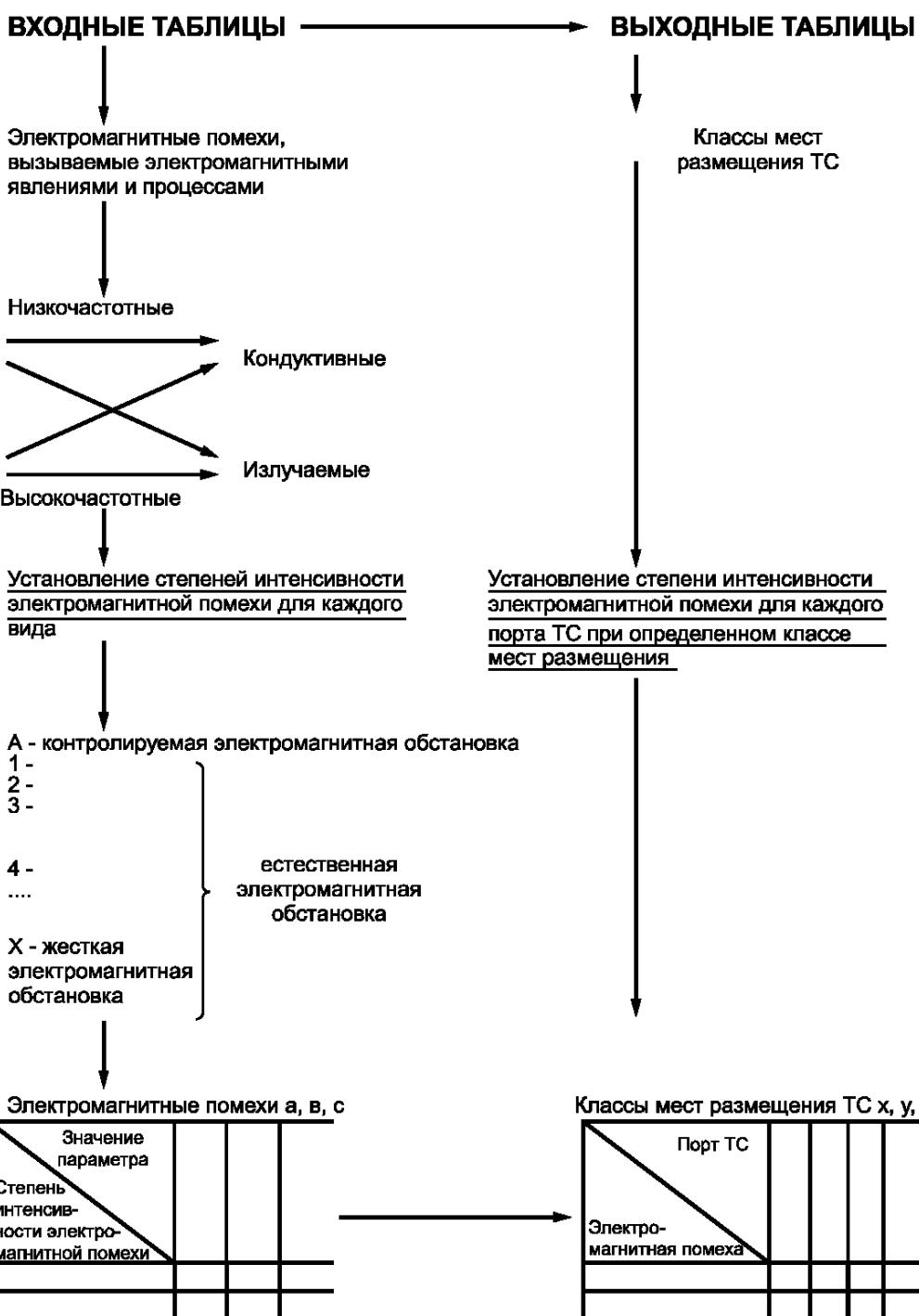
Рисунок 1 — Принципы классификации электромагнитной обстановки
