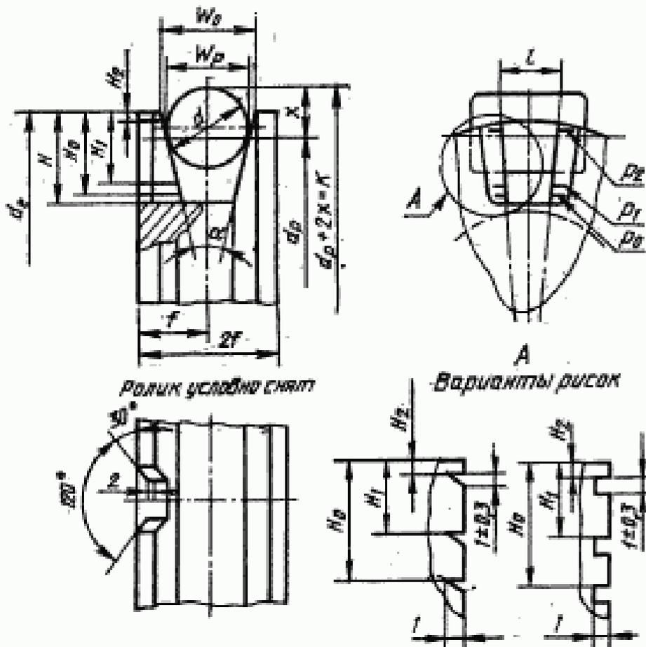
$W_0$  — ширина канавки по наружному диаметру;  $W_p$  — расчетная ширина;  $2f$  — ширина обода шкива;  $\alpha$  — угол канавки шкива;  $d_p$  — расчетный диаметр;  $d_0$  — наружный диаметр шкива;  $d$  — диаметр измерительного ролика;  $N$  — глубина канавки;  $x$  — расстояние от расчетного диаметра шкива до касательной плоскости к ролику, расположенной параллельно оси шкива;  $l$  — ширина паза
