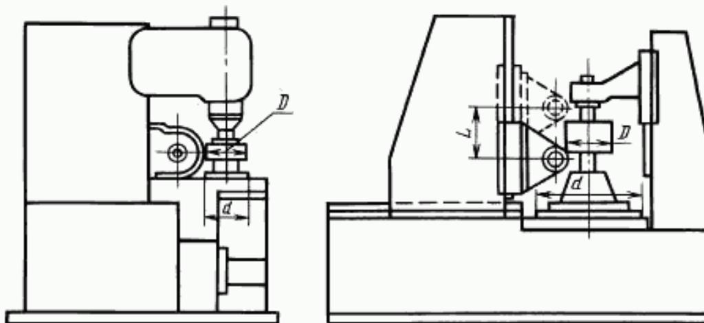
$D$  — наибольший диаметр обрабатываемого колеса (прямозубого),  $L$  — наибольшая длина вертикального перемещения инструментального суппорта (стола),  $d$  — диаметр стола или фланца шпинделя изделия
