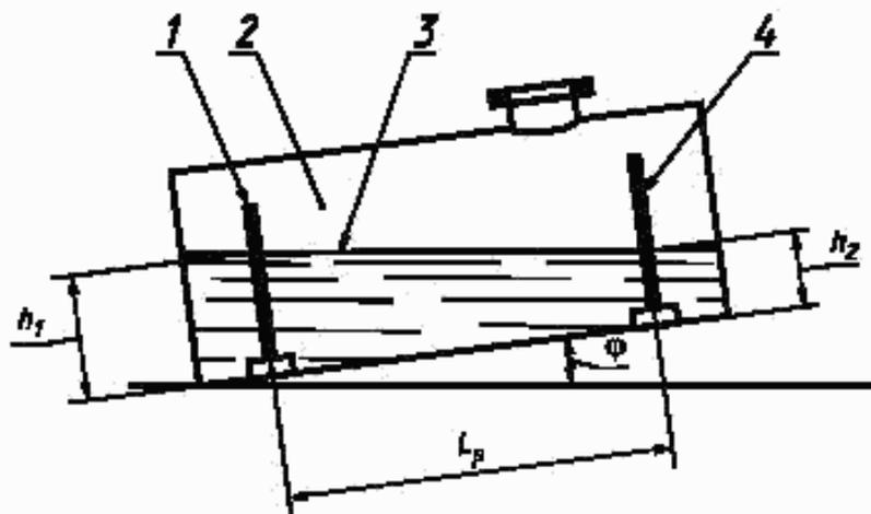
1,4 — измерительные металлические линейки; 2 — резервуар; 3 — вода
