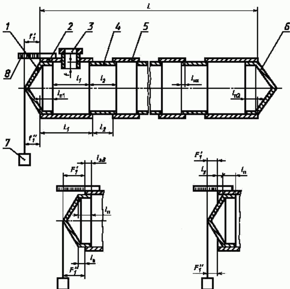
1, 6 – днища; 2, 4, 5 – пояса; 3 – горловина; 7 – отвес; 8 – измерительная металлическая линейка
