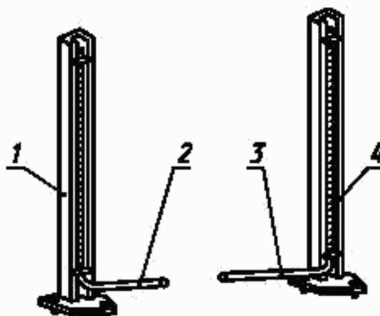
1, 4 — подставки; 2, 3 — водомерные трубки
