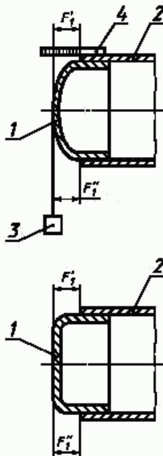
1 — днище; 2 — понос; 3 — отвес; 4 — измерительная металлическая линейка
