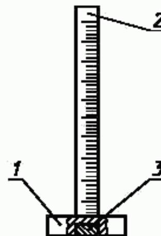
1 — основание; 2 — измерительная металлическая линейка; 3 — магнитный держатель
