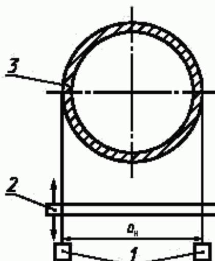
1 — двойной отвес; 2 — измерительная рулетка; 3 — резервуар;  $D_n$  — наружный диаметр цилиндрической части резервуара
