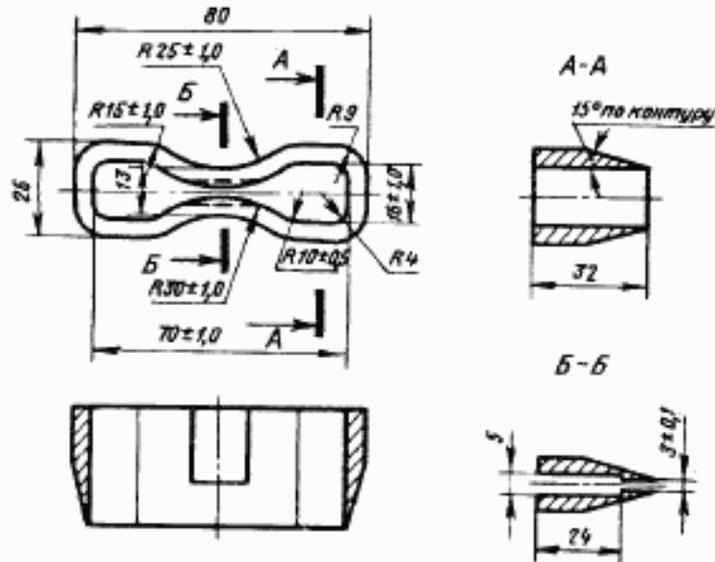
Схема штампа для нанесения меток
